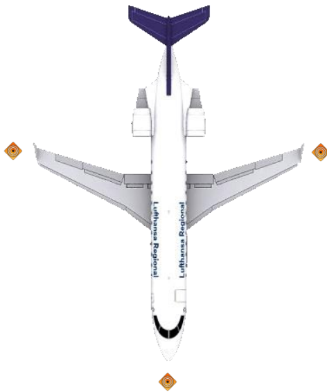
Slika 11.3.2; Postavitev varnostnih stožcev pri letalu z motorji na repu na samoizhodnih parkirnih mestih .
