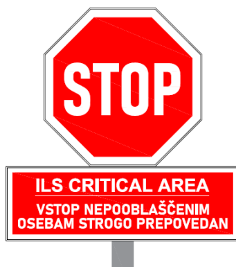
Slika 6.4.4; Vertikalna signalizacija ILS-LOC kritičnega območja pred antenami.
