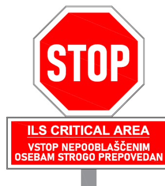
Slika 6.4.2; Vertikalna signalizacija ILS-GP kritičnega območja pred antenami.
