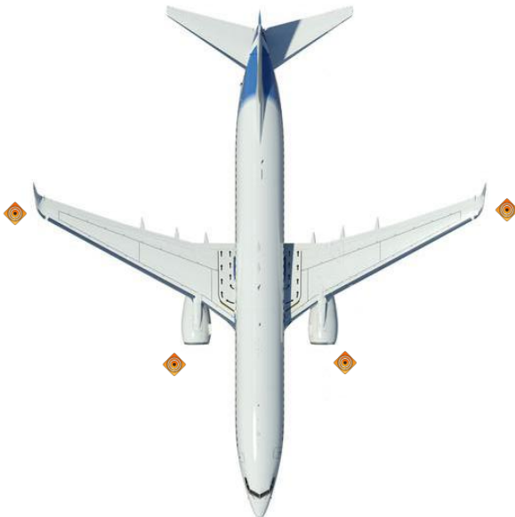
Slika 11.4.1; Položaj varnostnih stožcev v območju krila in motorjev (reaktivno letalo).
