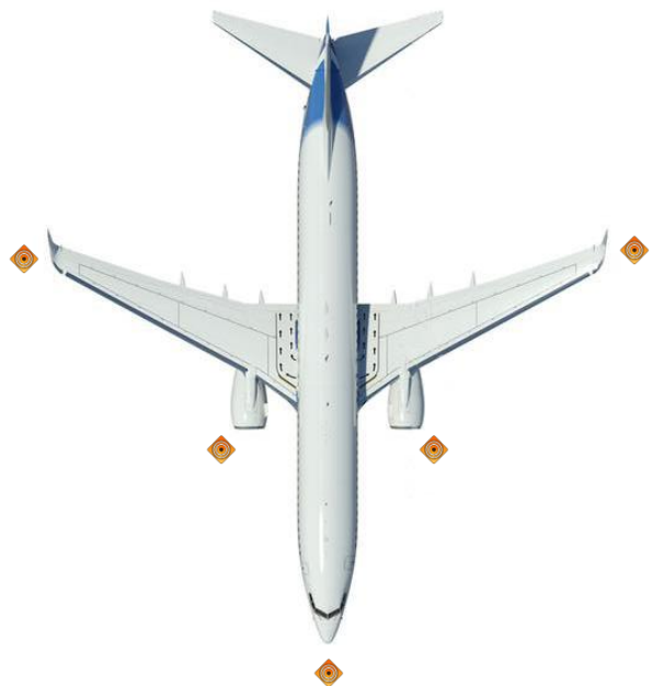
Slika 11.4.3; Položaj varnostnih stožcev v območju krila, motorjev in nosa (reaktivno letalo).
