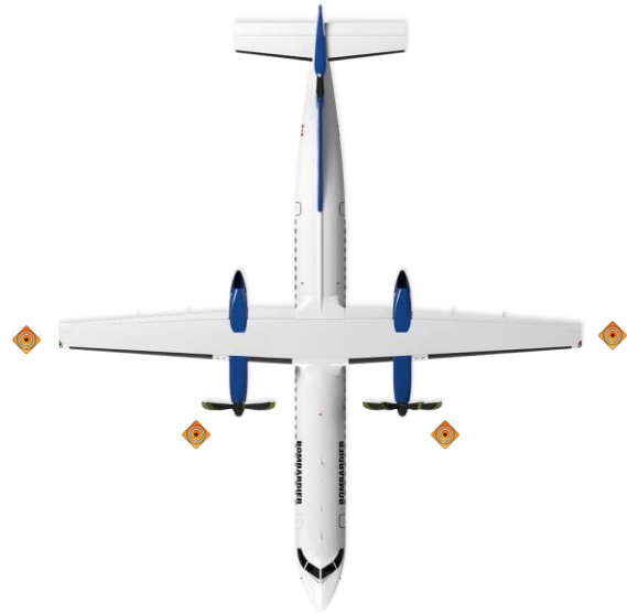
Slika 11.4.2; Položaj varnostnih stožcev v območju krila in motorjev (propelersko letalo).
