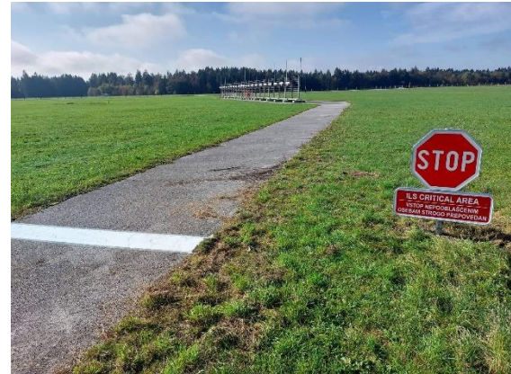
Slika 6.4.5; Način označitve ILS-LOC kritičnega območja pred antenami (oznaka in znak).
