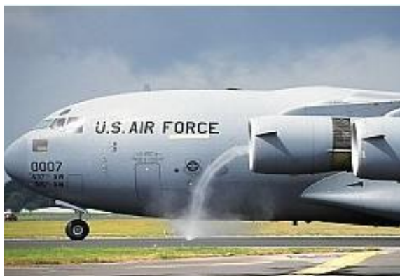
Slika 10.1.2; Zračni vrtinec pred delujočim motorjem transportira smeti iz tal v motor.
