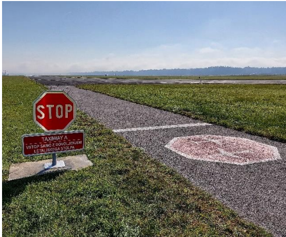
Slika 6.3.2; Način označitve mesta položaja čakanja za vstop na vozno stezo A (oznaka in znak).
