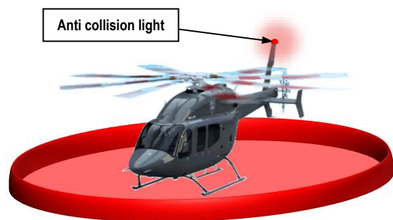
Slika 3.9.2; Nevarno območje pri rotirajočih lopaticah glavnega in repnega rotorja.
