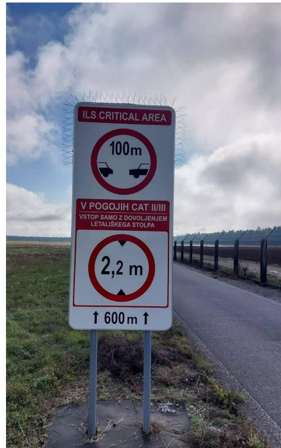
Slika 6.4.1; Vertikalna signalizacija ILS-GP kritičnega območja servisne ceste.
