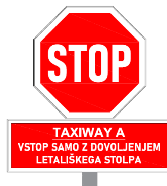
Slika 6.3.1; Znak na mestu položaja čakanja za vstop na vozno stezo A.
